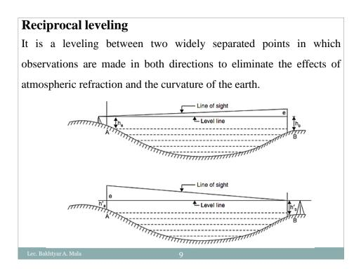
$$\begin{split} \Delta H_1 &= R_A - R^*{}_B \rightarrow \Delta H_1 = R_A - (R_B + e) \\ \Delta H_2 &= R'^*{}_A - R'_B \rightarrow \Delta H_2 = (R'_A + e) - R'_B \end{split}$$
